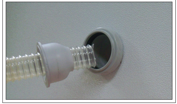
(Resim 2) Gırtlak hortumun giderden çıkarılır.
